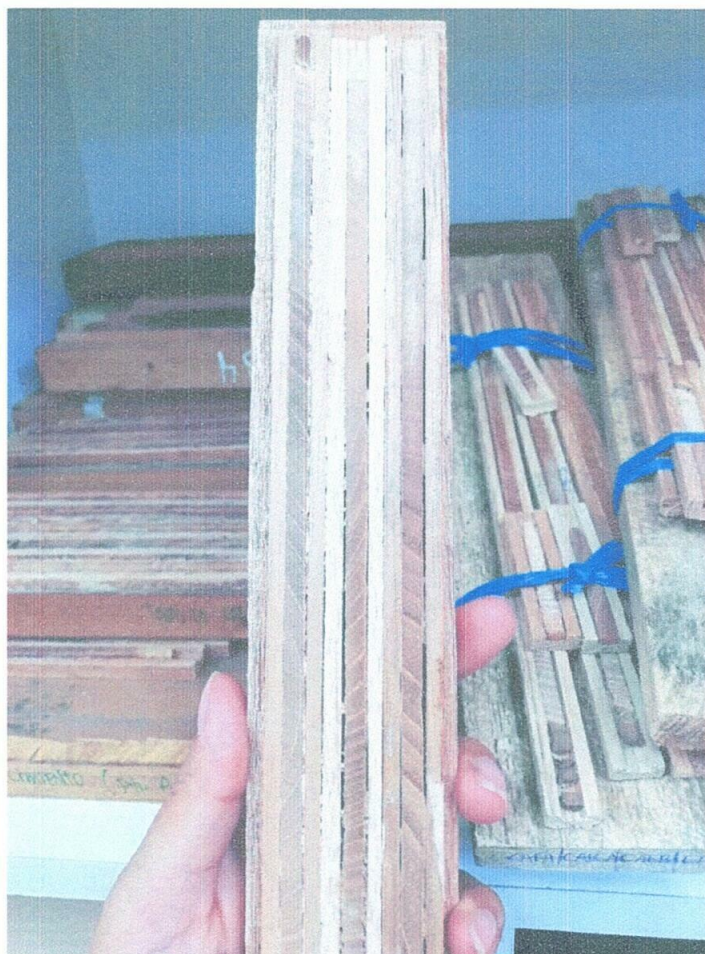
Figura 19. Muestras de leño extraídas con barreno de Pressler de investigaciones en dendrocronología
