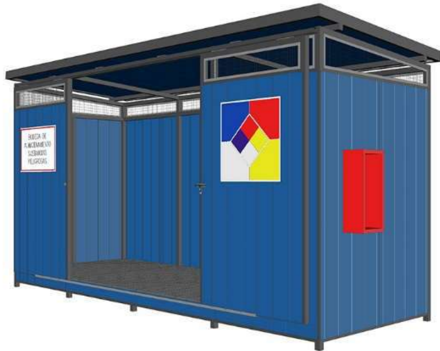
Imagen 7. Caseta de almacenamiento central o final de los materiales y/o residuos peligrosos.
